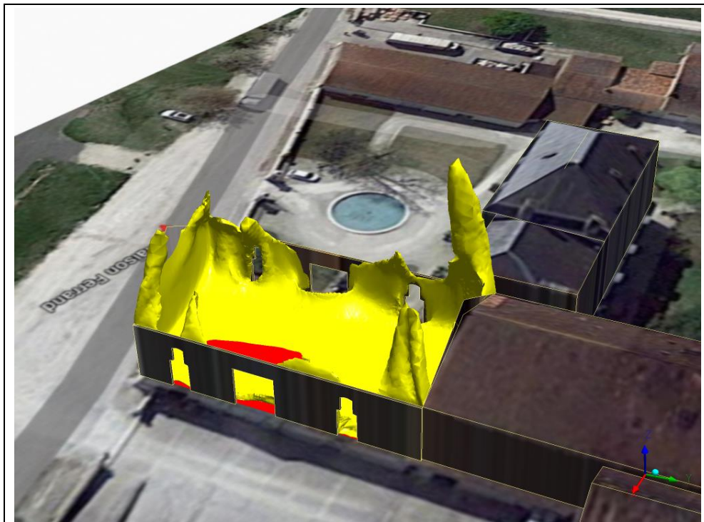
Figure 7 : Iso-surface représentant la flamme à une température de 700K localisée sur le chai
