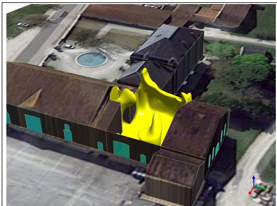
Figure 3 : Iso-surface représentant la flamme à une température de 700K localisée sur le chai
